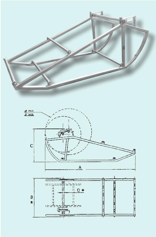
Porte-tourets à berceau ("luge") adapté pour le levage et le déroulage de tourets de câble en acier. Entièrement galvanisé. Équipé d'axe porte-touret.
