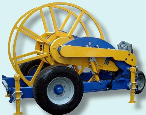
Enrouleuse conçue pour récupérer/tirer et dérouler câbles et conducteurs sur/à partir de tourets acier. Le touret est actionné par un moteur hydraulique entraîné par une centrale de puissance séparée ou à travers le circuit hydraulique d'un treuil ou d'une freineuse ou d'un treuil-freineuse.
