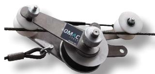
Dispositif de freinage pour chariots. Installé derrière la série de chariots, il permet le maintien de la distance entre les chariots. Châssis aluminium, roues en aluminium et caoutchouc montées sur roulements à billes.
