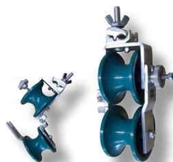
Chariot conçu pour le remplacement de conducteurs existants, avec mâchoire de tête pour câbles diamètre 10 à 20 mm. Deux roues nylon et châssis aluminium.
