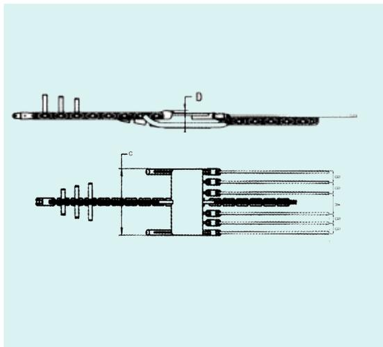
Palonnier de déroulage, de type fixe, pour faisceaux de 6 conducteurs, conçu pour la connexion d'un câble de traction avec 6 conducteurs.
