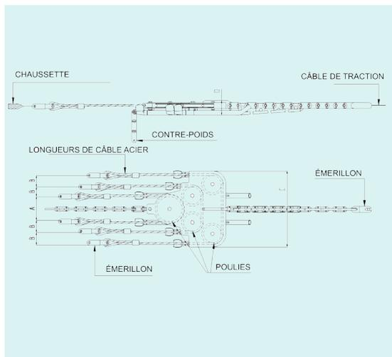
Palonnier de déroulage, de type équilibré, pour faisceaux de 6 conducteurs, conçu pour la connexion d'un câble de traction avec 6 conducteurs.
