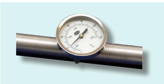
Thermomètre pour conducteurs. Le cadran de 80 mm de diamètre, avec capteur incorporé, peut être aisément fixé sur le conducteur à travers une fixation élastique. Double échelle (°C et °F).
