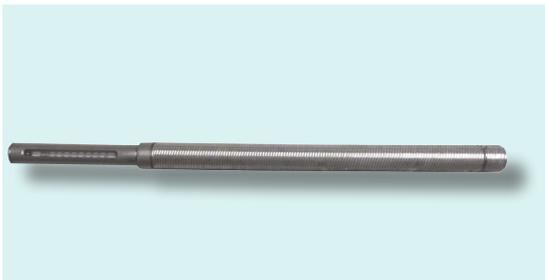
Thermomètre pour conducteurs, consistant en un bulbe reproduisant la forme et les dimensions du conducteur. Lecture colonne, échelle en degrés Celsius (°C). Fourni avec mallette.
