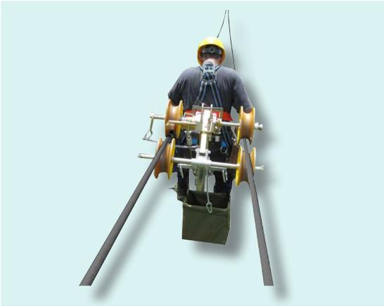
Bicyclette d'inspection pour lignes électriques à simple conducteur ainsi qu'en faisceau double, triple et quadruple. Galets nylon montés sur roulements à billes. Conçue pour la visite des conducteurs. Munie de disque de frein de type négatif et d'un frein de sécurité qui grippe le conducteur. Munie de ceinture de sécurité et de compteur de mètres. Inclinaison maxi de la ligne 25%.
