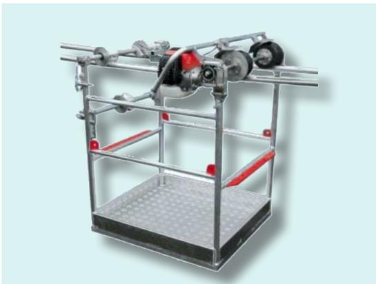
Nacelle d'inspection motorisée pour lignes électriques à double faisceau (2 conducteurs). Construite en alliage léger avec réas nylon montés sur roulements à billes. Essieu de transmission avec roues caoutchouc à haute adhérence.
