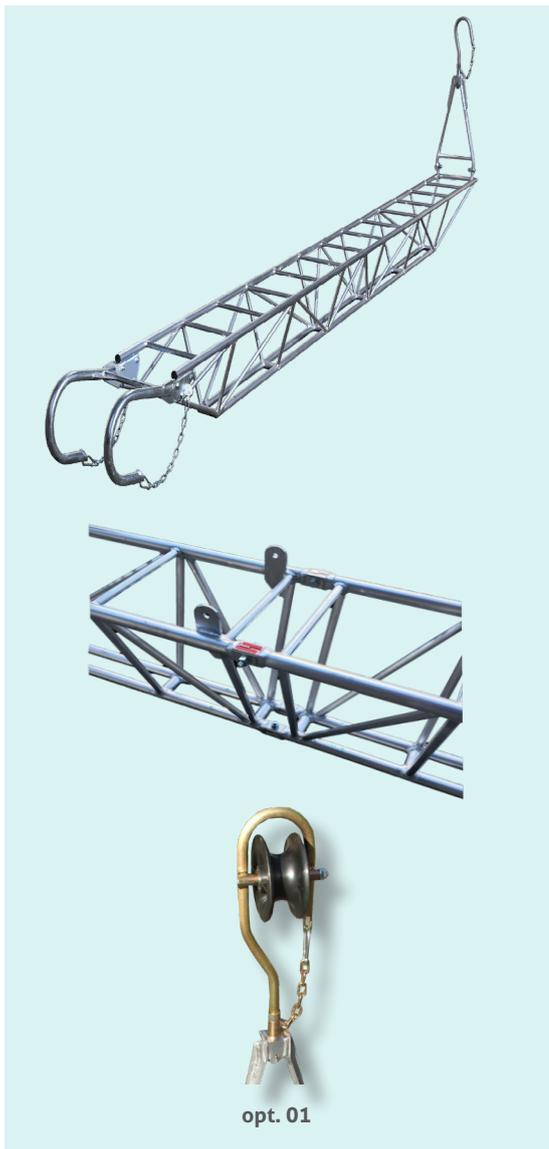
Échelle d'ancrage construite en alliage aluminium léger, avec marches en matériau anti-glissement et crochets de suspension en acier galvanisé à chaud. L'échelle est équipée de crochet fixe pour pylône, ouverture 220 mm, et d'un crochet tournant pour l'appui sur le conducteur, ce qui permet d'utiliser l'échelle en position horizontale. Les échelles sont à section trapézoïdale.
