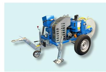
Argano a funzionamento idraulico, adatto al tiro di una fune nella tesatura di linee elettriche aeree. Un circuito idraulico permette di variare la velocità di rotazione dei cabestani in modo continuo in entrambi i sensi, agendo su un solo comando.
