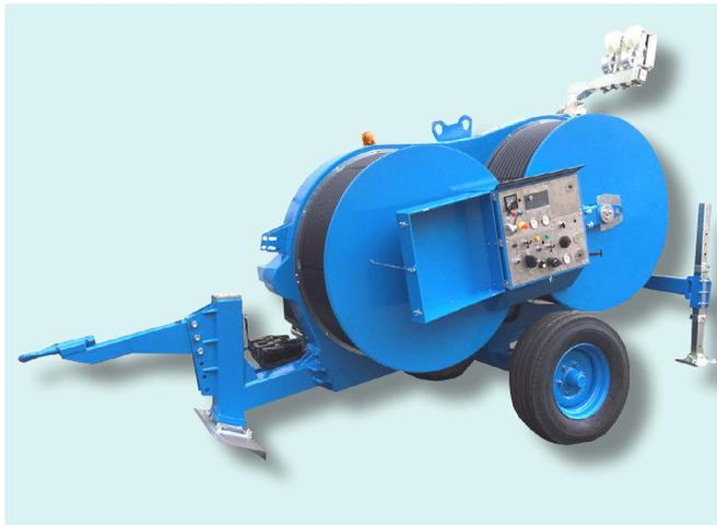
Macchina a funzionamento idraulico in grado di operare sia come freno sia come argano, adatta a tesare una o due funi o conduttori. Un circuito idraulico consente di esercitare una forza di frenatura costante anche al variare della velocità di stendimento. In uso argano, il circuito idraulico permette di variare la velocità in entrambe le direzioni.
