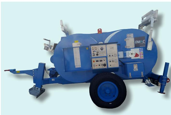
Macchina a funzionamento idraulico in grado di operare sia come freno sia come argano, adatta a tesare 1, 2, 3 o 4 funi o conduttori. Un circuito idraulico consente di esercitare una forza di frenatura costante anche al variare della velocità di stendimento. In uso argano, il circuito idraulico permette di variare la velocità in entrambe le direzioni.
