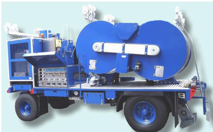
Macchina a funzionamento idraulico in grado di operare sia come freno sia come argano, adatta a tesare 1, 2, 3 o 4 funi o conduttori. Quattro circuiti idraulici consentono di esercitare una forza di frenatura costante anche al variare della velocità di stendimento. I quattro circuiti possono essere utilizzati indipendentemente o simultaneamente con ripartizione automatica delle forze. In uso argano, quattro circuiti idraulici (chiusi) permettono di variare la velocità in entrambe le direzioni.
