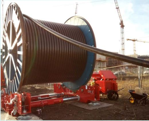
Porta bobine in acciaio, utile durante lo stendimento del cavo, con possibilità di movimentazione idraulica della bobina stessa, con trasmissione di potenza dalla centrale idraulica.
