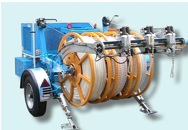
Carrello motorizzato per trasporto bobine, studiato per il recupero o lo svolgimento di funi e conduttori dalle bobine in legno o acciaio. Il carrello può ospitare fino a 3 o 4 bobine che, azionate tramite un motore idraulico, consentono sia di recuperare (uso argano) che di svolgere, anche frenando, la fune o conduttore dalla bobina.
