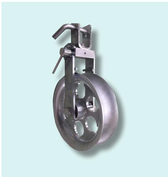
Carrucola singola per stendimento funi di guardia. Ruota in acciaio zincato montata su cuscinetti a sfera. Telaio in acciaio zincato con dispositivo guida-fune antiscarrucolamento.
