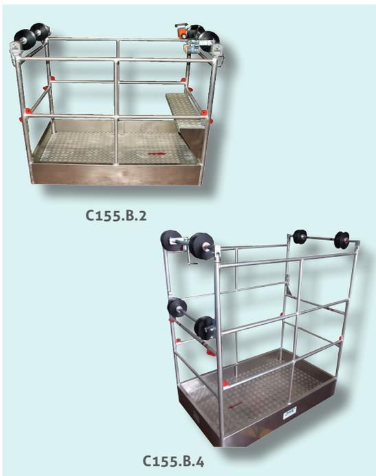
Carrello d'ispezione biposto per linee elettriche a conduttore binato, trinato o quadrinato. Struttura in lega leggera d'alluminio con ruote in nylon montate su cuscinetti a sfere. Freno di stazionamento e contametri.
