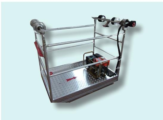
Carrello d'ispezione biposto motorizzato per linee elettriche a conduttore binato, trinato o quadrinato. Struttura in lega leggera d'alluminio con ruote in nylon montate su cuscinetti a sfere. Ruote motrici rivestite di poliuretano ad alto coefficiente di attrito. Assale di trasmissione con ruote in gomma ad alta aderenza. Freno di stazionamento e contametri.
