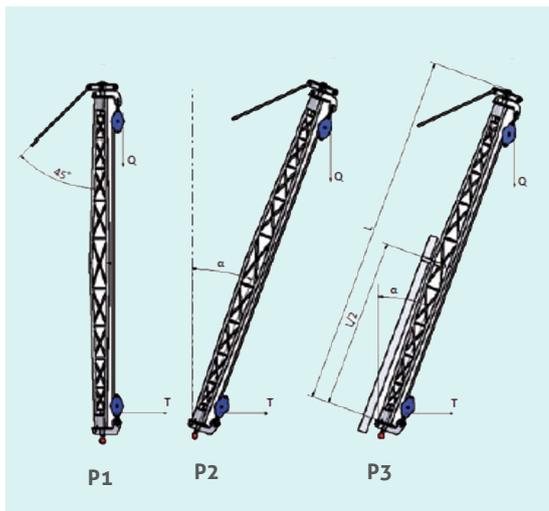
Falconi realizzati in tralicciati di lega leggera di alluminio saldati TIG, composti da due o più tronchi separati.
